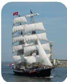
**A bord de Mercedes**, ce grand voilier de 50 mètres est un brick. Son gréement porte deux phares carrés complets avec cinq étages de vergues et 900 m<sup>2</sup> de voiles, qui assurent une navigation rapide et confortable. Mercedes abrite un bar et un restaurant, il est possible de déjeuner à bord (non compris dans le prix de la sortie).
